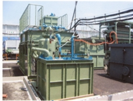
pH中和装置(炭酸ガス注入方式) 処理能力/10~50m³/H(5種類)
